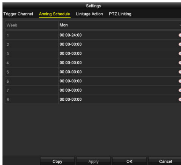
Рисунок 8-7 Установка расписания постановки на охрану тревожного входа
