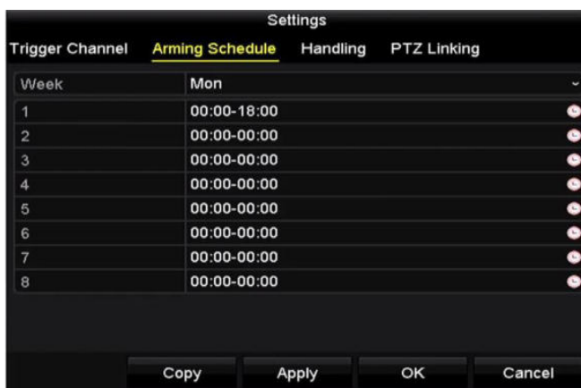
Рисунок 9-17 Установка расписания постановки на охрану
