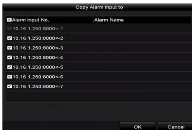
Рисунок 8-9 Копирование настроек тревожного входа
