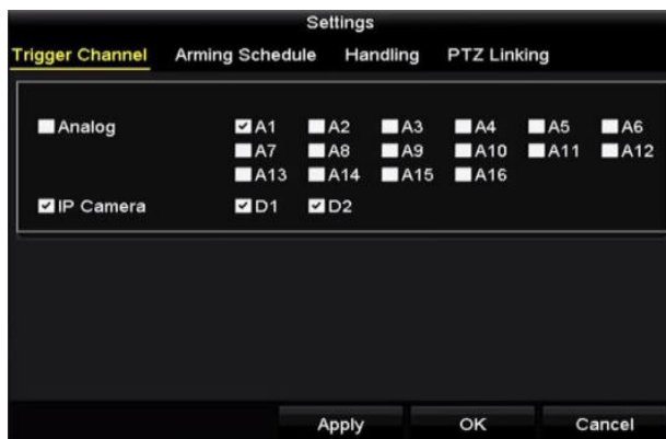
Рисунок 9-16 Установка срабатывающих каналов POS
