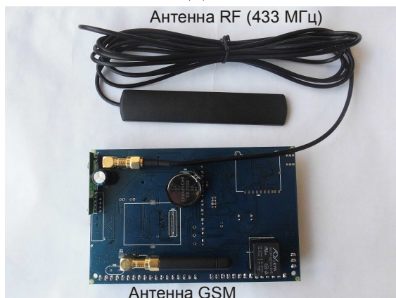
Внутренняя антенна GSM
