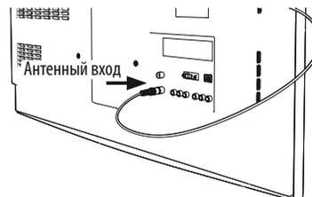
Рис.2 Подключение исполнения антенны «Стриж 3.0 П» или «Стриж 3.0 5В» к телевизору
