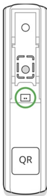
Мы рекомендуем устанавливать проводной датчик на расстоянии не более 1 метра – увеличение длины провода повышает шанс его повреждения и ухудшает качество связи между датчиками.
