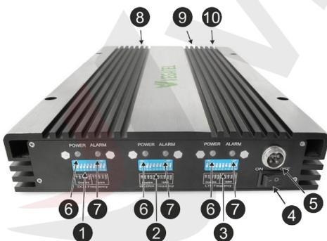
1 - 1800 МГц – ручная регулировка усиления для GSM-1800 (2G) / LTE1800 (4G).
