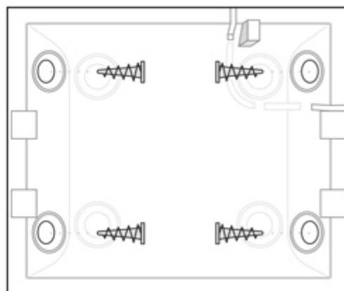
1. Закрепите панель SmartBracket на поверхности комплектными шурупами, используя не менее двух точек фиксации (одна из них — над тампером). Выбрав другие средства крепежа, убедитесь, что они не повреждают и не деформируют панель.
