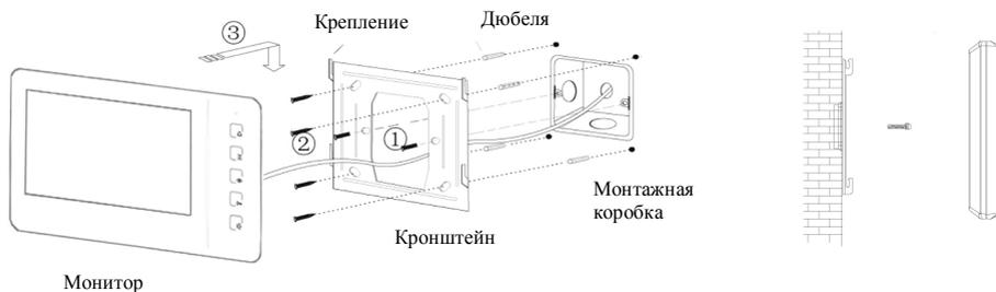
Рисунок 2: Установка монитора на стену
