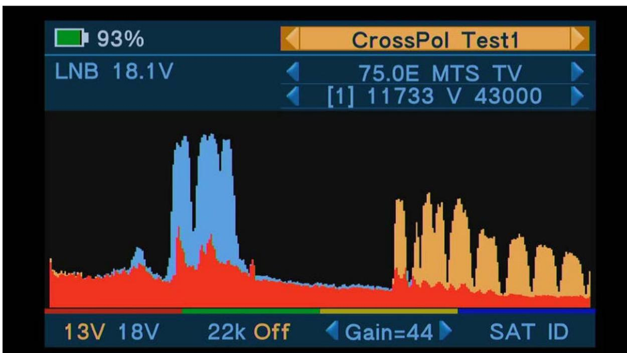
Вращая конвертер вокруг своей оси можно свести к минимуму проникновение поляризации (дублирование красного спектра) и получить максимальное соотношение значения сигнал-шум.
