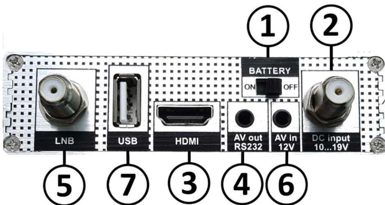
1. Переключатель **BATTERY ON/OFF** служит для Включения / Выключения прибора. Когда прибор не используется – отключайте батарею, установив переключатель в позицию OFF. Это позволит увеличить время работы прибора.
