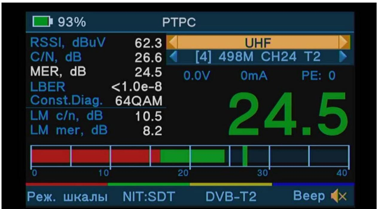
**MER** (Modulation Error Ratio) – Коэффициент ошибки модуляции несущей. Цифровой показатель качества сигнала. Довольно медленно вычисляется «на лету» из диаграммы конstellляции. Показывает насколько сильны фазовые искажения, не видимые при измерении сигнал-шум. Графически это диаметр пятна диаграммы созвездия. Чем оно больше – тем хуже качество цифрового сигнала.
