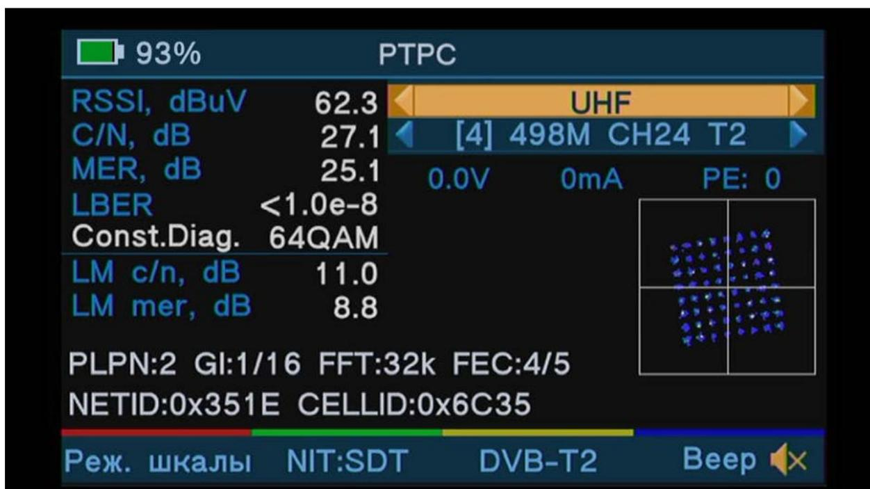
**Constellation Diargam** – Диаграмма созвездия (Конstellляция). Графическое отображение параметра MER. Позволяет по характерным позициям точек определить стандарт вещания и используемую модуляцию, и оценить качество цифрового сигнала по диаметру пятна. Для удобства восприятия плотности точек используется цветовая схема: Красный цвет – плотность максимальная, далее по убыванию – желтый, зеленый, синий цвета. Синий – минимальная плотность точек.
