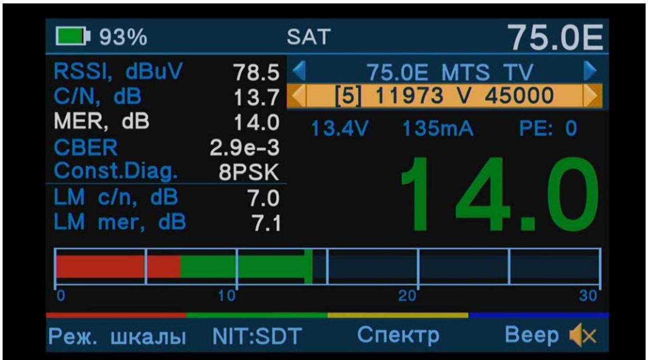
**MER** (Modulation Error Ratio) – Коэффициент ошибки модуляции несущей. Цифровой показатель качества сигнала. Довольно медленно вычисляется «на лету» из диаграммы констелляции. Показывает насколько сильны фазовые искажения, не видимые при измерении сигнал-шум. Графически это диаметр пятна диаграммы созвездия. Чем оно больше – тем хуже качество цифрового сигнала.
