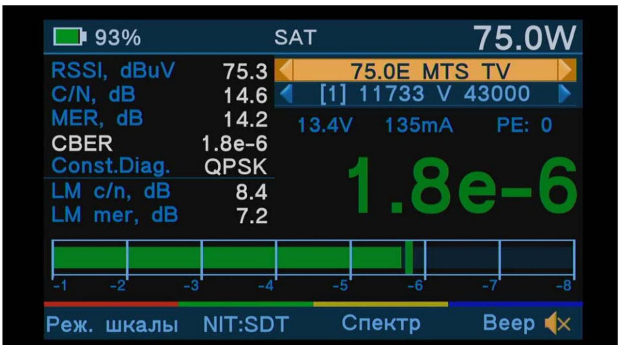
**CBER** (Channel Bit Error Ratio) – Частота появления канальных ошибок. Индикатор полезный для нахождения порога приема, так называемое значение QEF (Quasi Error Free), который используется для вычисления запаса по сигналу.
