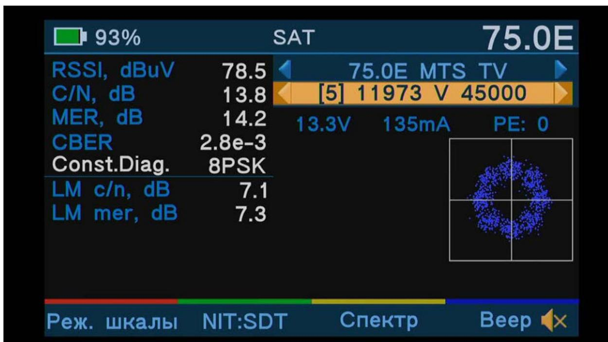
**Constellation Diagram** – Диаграмма созвездия (Конstellляция). Графическое отображение параметра MER. Позволяет по характерным позициям точек определить стандарт вещания и используемую модуляцию, и оценить качество цифрового сигнала по диаметру пятна. Для удобства восприятия плотности точек используется цветовая схема: Красный цвет – плотность максимальная, далее по убыванию – желтый, зеленый, синий цвета. Синий – минимальная плотность точек.
