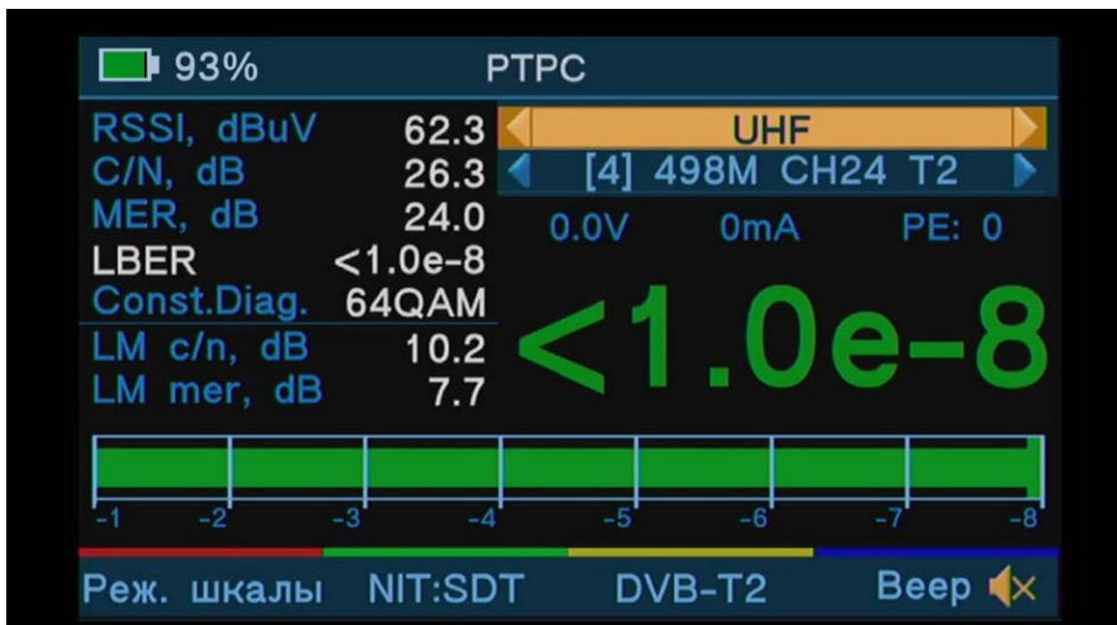
**LBER** (LDPC Bit Error Ratio) - индикатор работы FEC декодера. Показывает сколько ошибок все еще не исправлено системой исправляющей ошибки.
