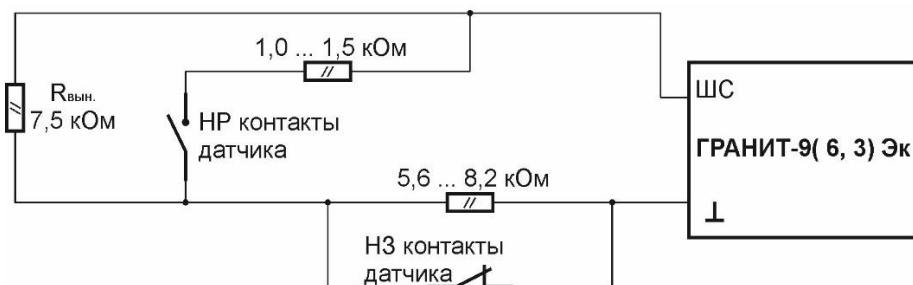
Рис.6. Схема включения технологических датчиков в ШСТ.
