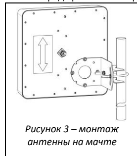
Рисунок 2 – монтаж антенны на мачте
