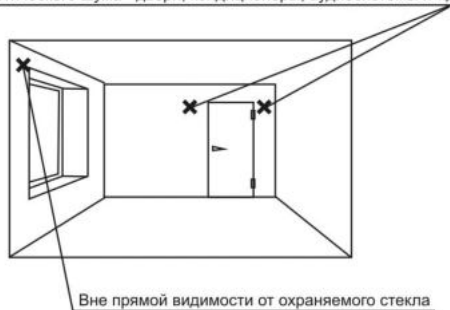
Рис.3 Запрещенные места установки
