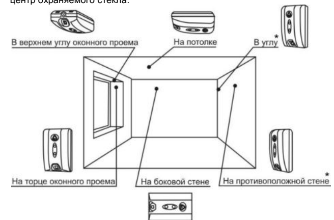
Рис.2 Возможные варианты установки извещателя
