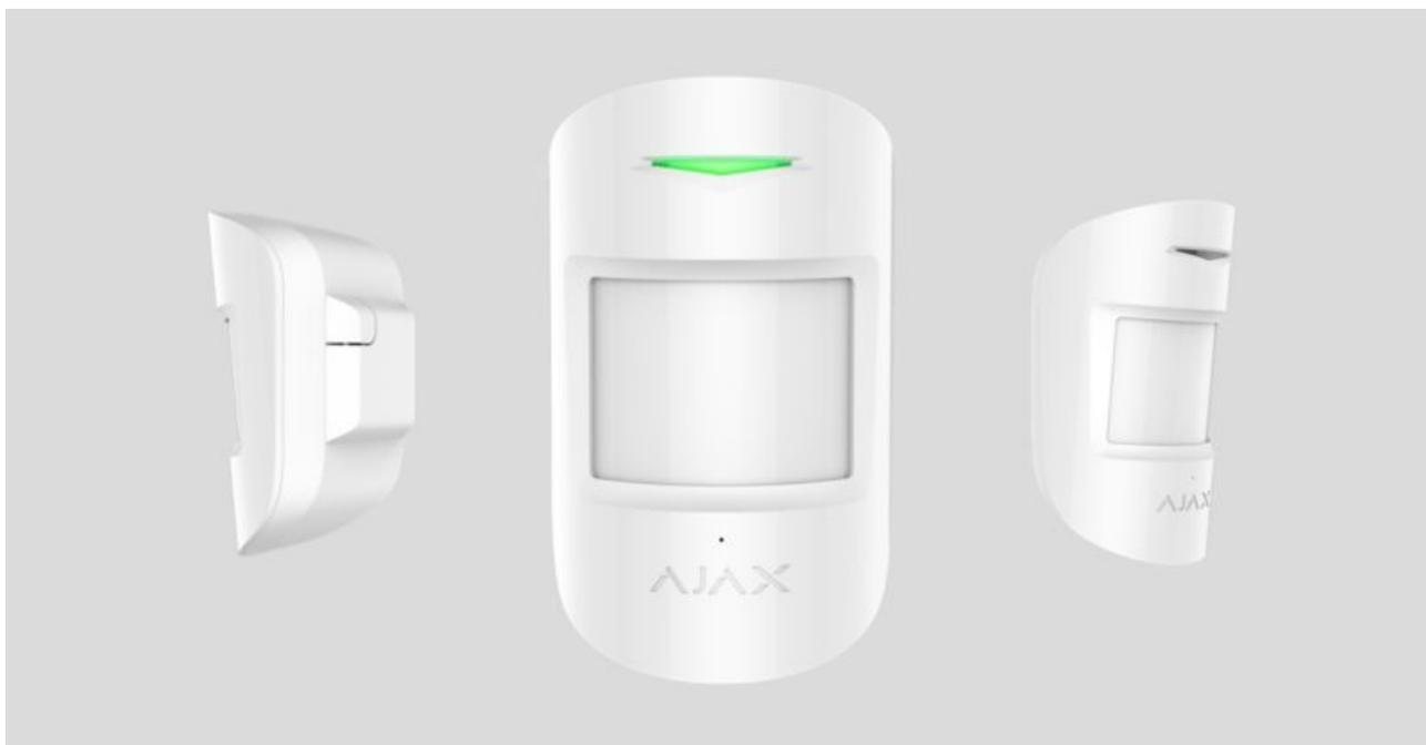
**CombiProtect** — устройство, совмещающее беспроводной датчик движения с углом обзора в 88.5° и дальностью в 12 метров, а также датчик обнаружения разбития стекла с дальностью в 9 метров. Может игнорировать животных, определяет человека в зоне защиты с первого шага. Работает до 5 лет от комплектной батареи и используется внутри помещений.
