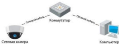
Рисунок 3-2 Соединение через коммутатор или роутер
