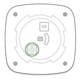
Чтобы произошло обнаружение и сопряжение, устройство должно находиться в зоне действия радиосвязи хаба (на одном охраняемом объекте). Если HomeSiren уже была привязана к другому хабу, выключите сирену и повторите стандартную процедуру добавления.
