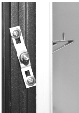
Установка ригеля на POLAIR 1200
