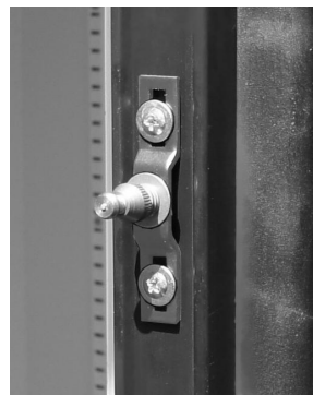
Установка ригеля на остальные холодильники
