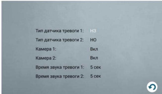
**Тип датчика тревоги 1,2** – выбор типа контакта подключенного датчика тревоги к разъему CAM1, CAM2. Когда срабатывает датчик, формируется сигнал тревоги, производится захват фото с тревожной видеокамеры. Одновременно с этим звучит звуковая сирена. Для выбора параметра доступны значения: НО (нормально-открытый), НЗ (нормально-замкнутый) и «Выкл.».
