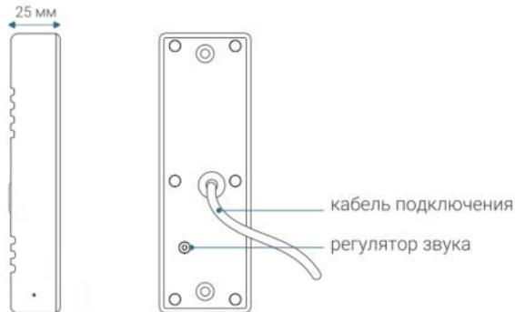
ТАБЛИЦА 3. Конструкция вызывной панели
