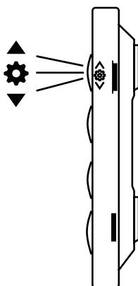
Кнопка-колесо, расположенная на боковой части монитора CTV-M1701S, имеет следующие функции:
