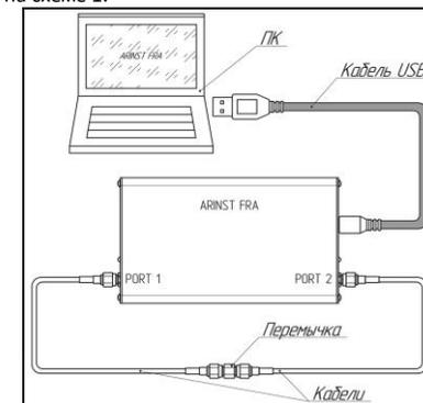
Схема 1 – Калибровка прибора
