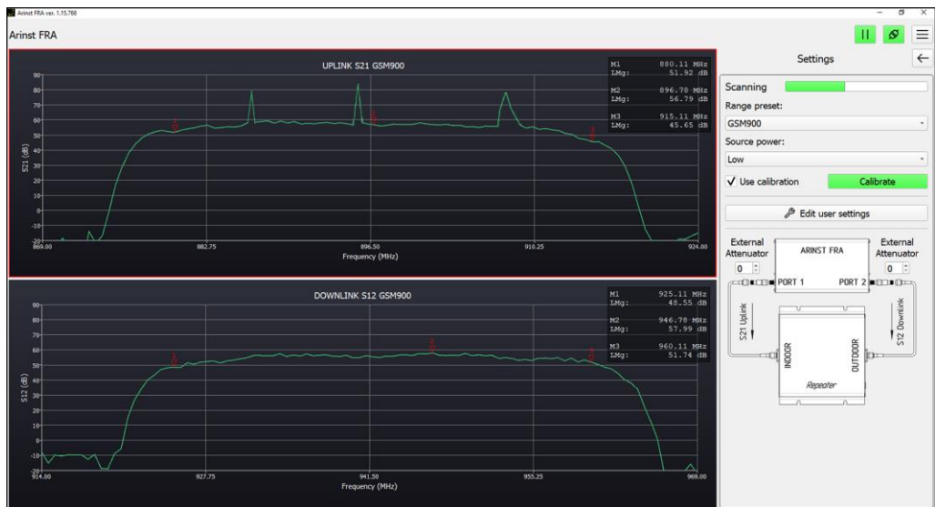
Рисунок 10.10 – Самовозбуждение репитера в канале Uplink
