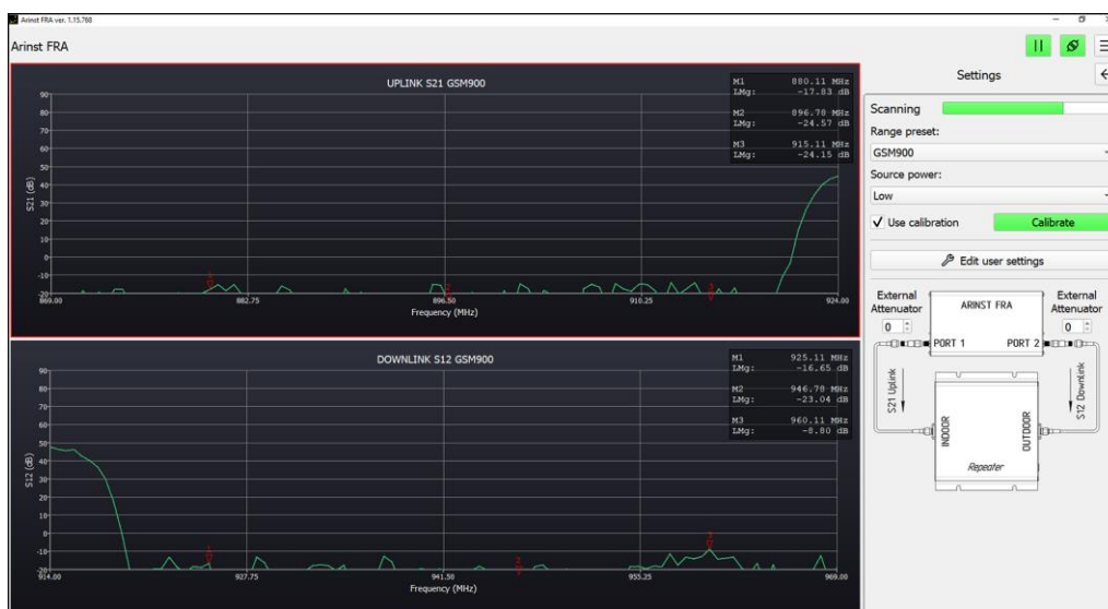
Рисунок 10.9 – График АЧХ при неправильном подключении репитера к прибору
