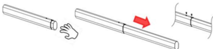
Рис.1 Соедините главную стрелу со вспомогательной стрелой 2 винтами
